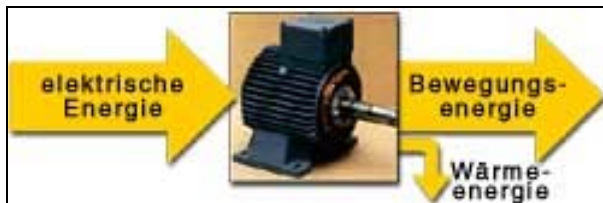
Abbildung 4: Energieaufnahme und Energieabgabe eines Elektromotors.
