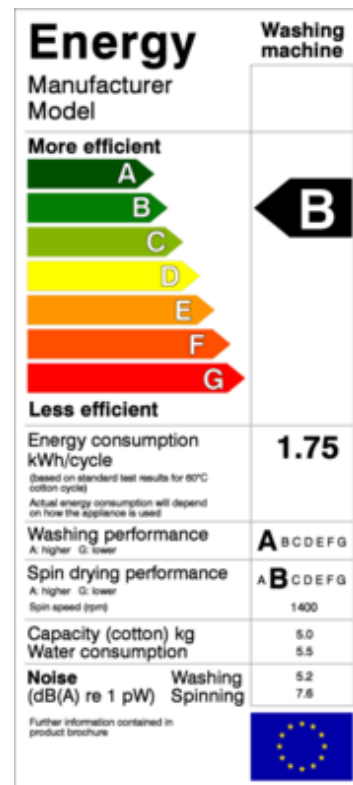
Abbildung 3: Europäische Energieverbrauchskennzeichnung für eine Waschmaschine.
