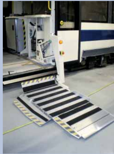
Einsteigehilfe für RollstuhlfahrerInnen
