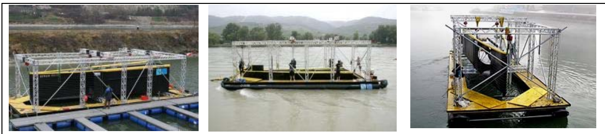
Abbildung 17: Stromboje vor dem Einbringen
